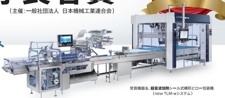
受賞機器名：超音波加熱シール式横形ピロー包装機（new TLM-αシステム）
